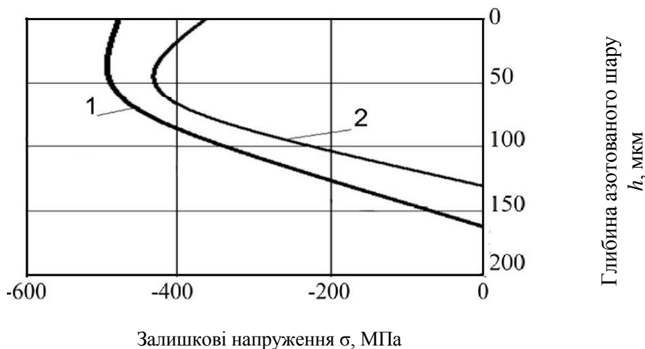
Рис. 3.10. Розподіл залишкових напружень по глибині азотованого шару зразків зі сталі 12Х18Н10Т: 1- дискретна лазерна обробка + азотування; 2 - газове азотування
